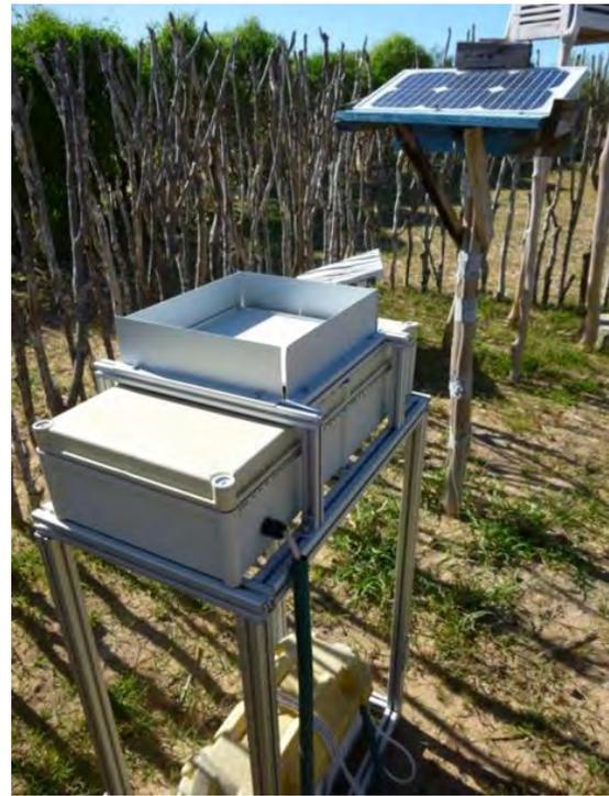
FIGURE 3.2.: Configuration de la balance dans le village Efoetsy au littoral de la région de Mahafaly (sud-ouest de Madagascar) montrant une plate-forme en aluminium protégée par un pare-brise, un panneau solaire alimentant l'équilibre et un enregistreur de données.
