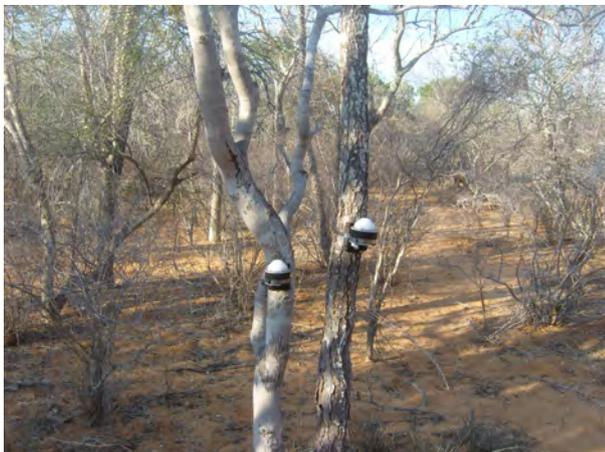
FIGURE 5.7.: L'installation des dendromètres à haute résolution.
